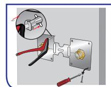
Insérer les chevilles Moly® en veillant à ce que les 2 ergots soient positionnés dans les 2 encoches. Serrer avec la pince adéquate. Une fois la cheville expansée, ôter la vis pour éviter une sur-épaisseur de colle.
