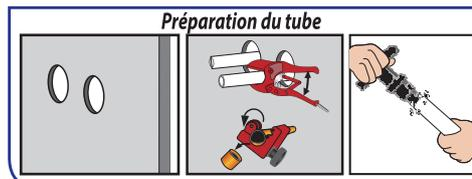
Après avoir percé 2 trous de Ø 63mm à l'aide d'une scie cloche (entraxe 150mm).
