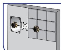
La platine, par son épaisseur réduite sera facilement noyée dans le ciment colle utilisé pour la pose des falences.
