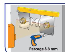
Positionner la platine à l'aide d'un niveau à bulle, ou grâce aux 4 petits trous horizontaux, à l'aide d'un niveau laser. Percer les 8 trous dans la cloison en veillant à ne pas percer les tubes.
