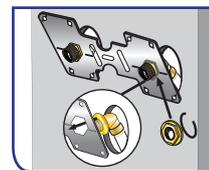
Insérer chaque coude dans le trou hexagonal de la platine. Le 6 pans empêche alors le coude de tourner, quel que soit le sens d'arrivée du tube.
